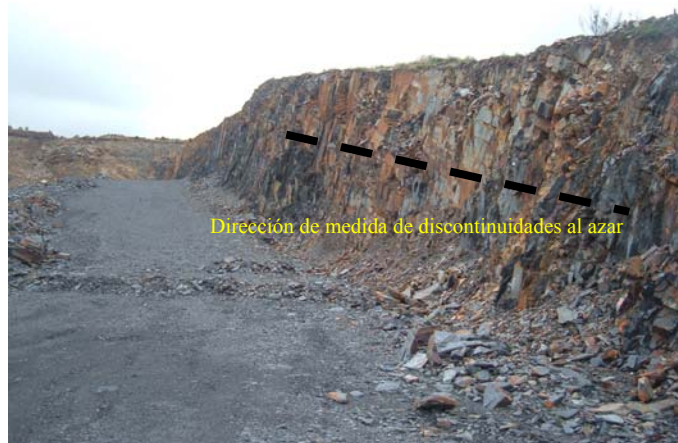
Foto 1: Transversal de medida de las discontinuidades al azar
