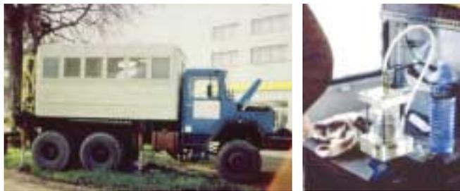
Figs. 5 y 6. Camión donde van montados los equipos de medida del piezocono. Detalle del piezocono.
